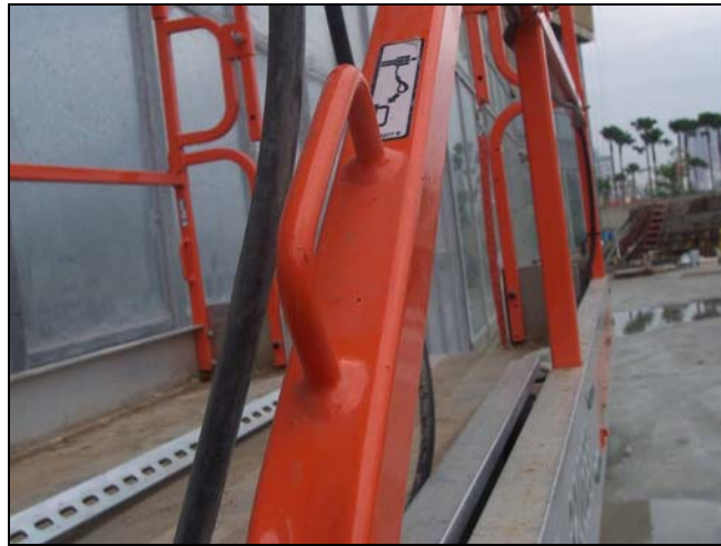
圖 5 製造商設計之安全帶繫掛點
