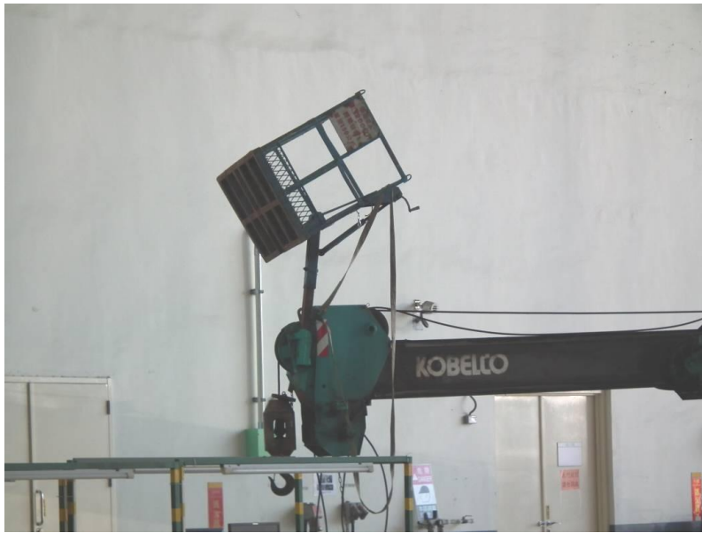
照片說明：災害時之搭乘設備被撞擊仰起
